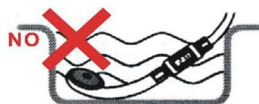
Cette unité offre le degré de protection IPX4 ne pas submerger le thermomètre dans l'eau
