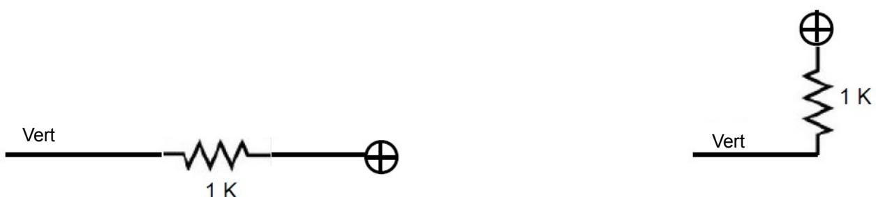
**NOTE:** la sortie doit mettre une résistance de 1 K à positif
