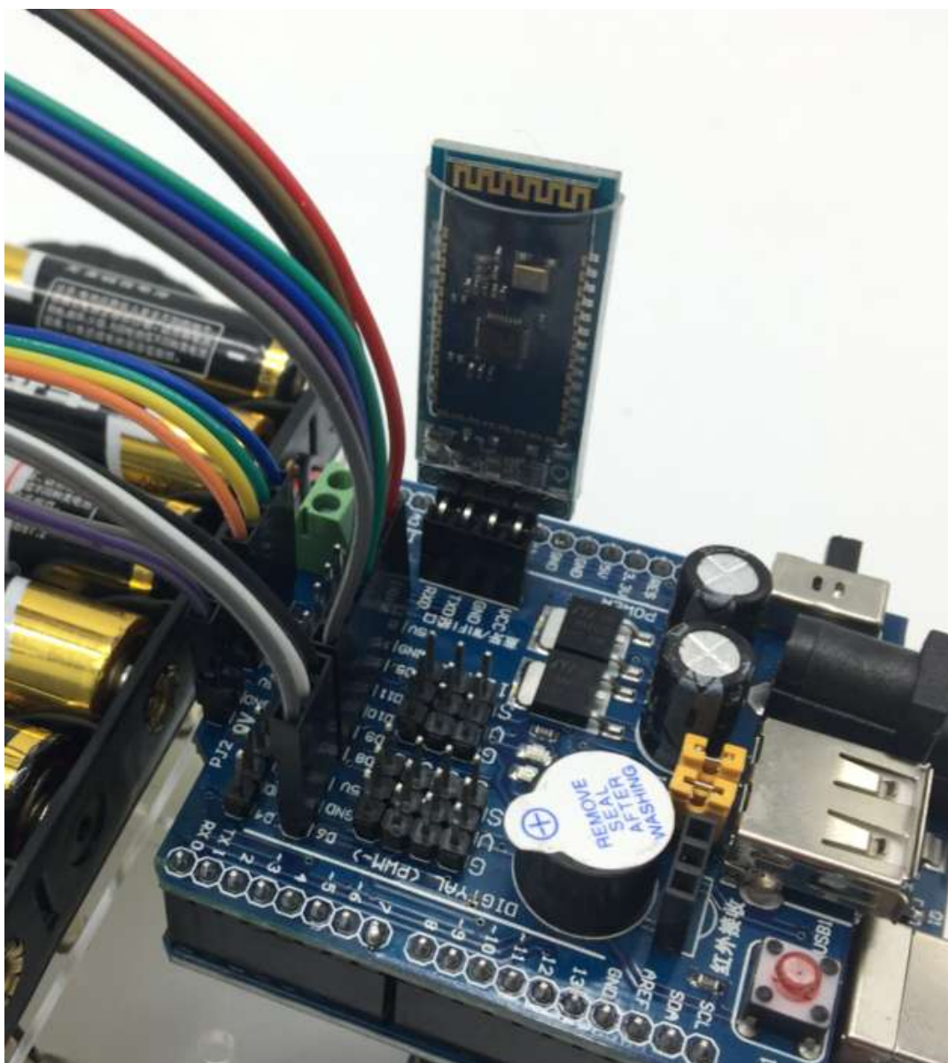
Figura 8 - 1 : Conectar el módulo Bluetooth según indica la imagen. Atención a la correcta polaridad
