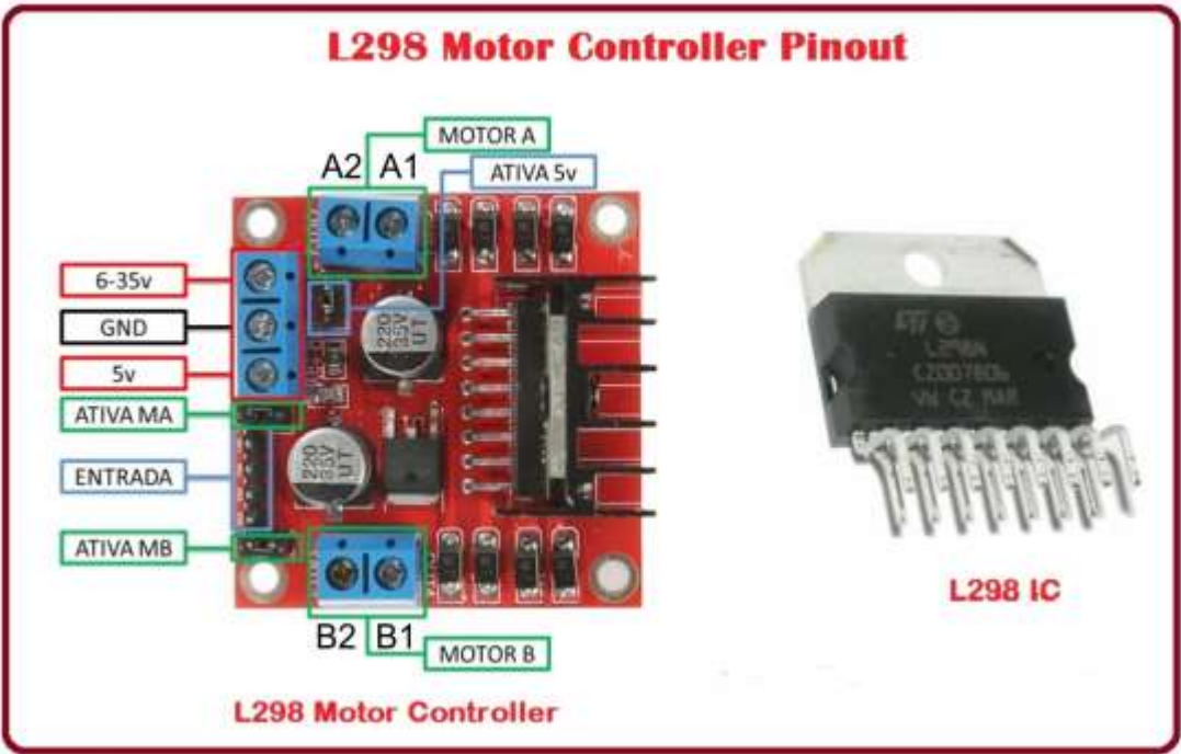
Figure 6- 3 : Connecter les câbles du moteur gauche à la partie gauche du module de contrôle des moteurs (bornes A1 et A2) et ceux du moteur de droite à la partie droite (bornes B1 et B2)
