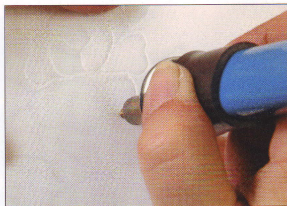
10. Modulando a baja temperatura la estación de pirograbado, en torno a los 200° C, podemos pirograbar diversos tejidos sin llegar a quemarlos.
