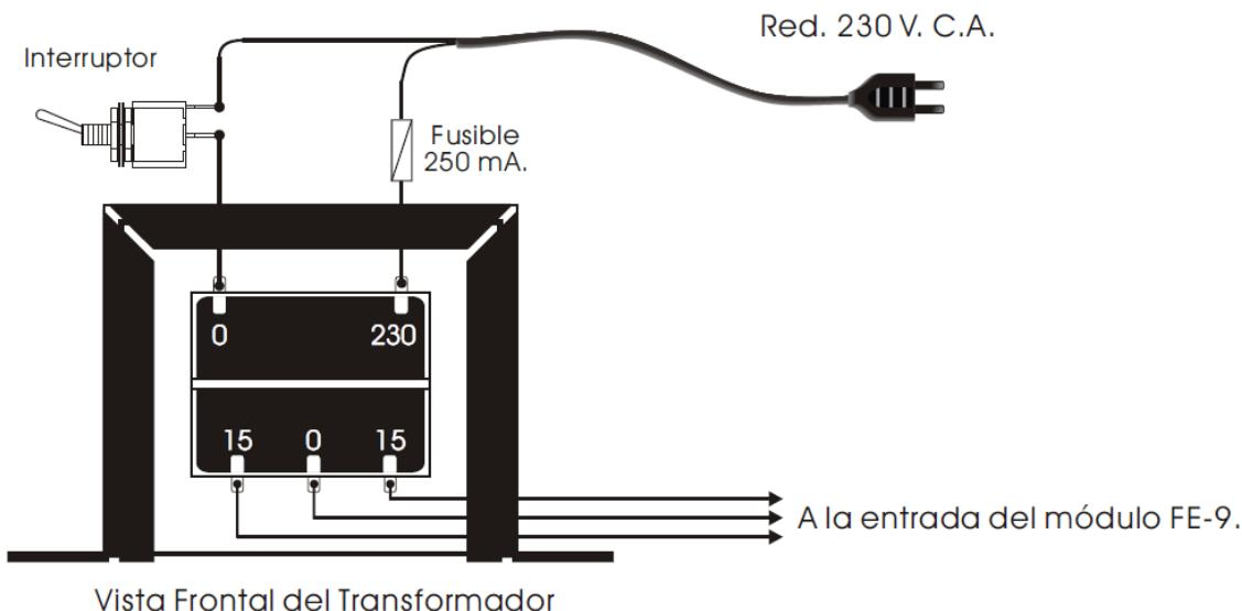
**CONEXIONADO DEL MODULO.** Una vez haya realizado el conexionado del transformador prosiga con el módulo. Compruebe primero que no circulan todavía los 230 v. de la red.
