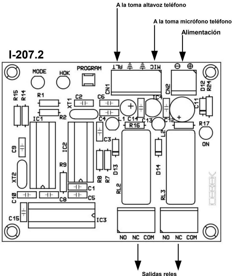
**CONEXION DE LA SALIDA. CARGA.** La salida se realiza mediante un relé, dispositivo que admite cualquier tipo de carga que no supere los 3 A. El relé dispone de tres terminales de salida. El Normalmente abierto en reposo (NA), el Normalmente cerrado en reposo (NC), y el Común. El funcionamiento de este mecanismo es idéntico a un interruptor, cuyos dos terminales serán el NA y el Común.
