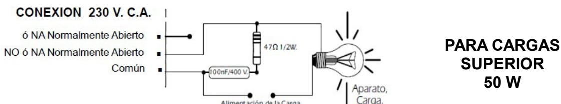
**NOTA:** para conectar cargas a 12 V. C.C., eliminar resistencia y poner solo condensador
