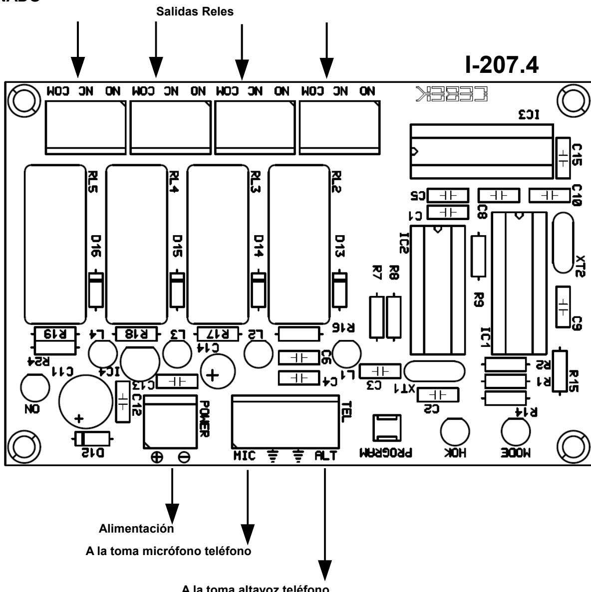
**CONEXION DE LA SALIDA. CARGA.** La salida se realiza mediante un relé, dispositivo que admite cualquier tipo de carga que no supere los 3 A. El relé dispone de tres terminales de salida. El Normalmente abierto en reposo (NA), el Normalmente cerrado en reposo (NC), y el Común. El funcionamiento de este mecanismo es idéntico a un interruptor, cuyos dos terminales serán el NA y el Común.
