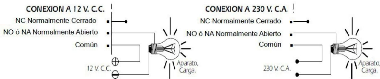
**CONSIDERACIONES SOBRE LA SALIDA.** Durante el funcionamiento del circuito, y según sea su carga, podrá producirse una fluctuación o un incorrecto funcionamiento de la salida. Si esto ocurre, instale un circuito antichispas entre los dos contactos del relé utilizados en la conexión, tal y como se muestra en el dibujo
