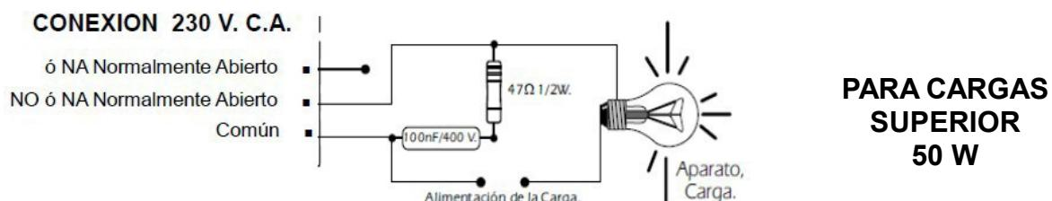
**NOTA:** para conectar cargas a 12 V. C.C., eliminar resistencia y poner solo condensador
