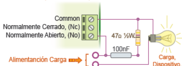
Fig. 2. Filtro anti-fluctuaciones del relé. (para cargas a 230 V. A.C. a partir de 50 W.).
