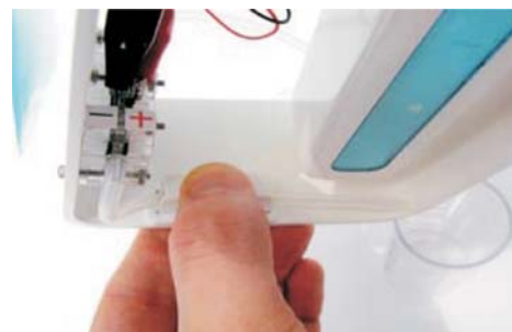
Paso 3 Espere un rato y entonces impulse con el dedo las aspas del ventilador para arrancarlo. Vea como gira a velocidad constante. Si el ventilador vuelve a pararse, desconecte las pinzas de cocodrilo e intercámbielas para reconectar la célula de combustible. La célula de combustible puede empezar la reacción una vez más (y más protones de hidrógeno pueden penetrar a través de la membrana).
