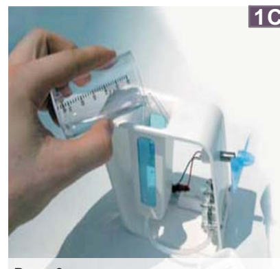
Paso 3 Vierta la disolución en el depósito de etanol y luego ciérrelo con la tapa.
