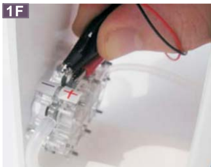
Paso 6 Si el sistema se ha conectado correctamente, las aspas deberían empezar a girar al cabo de un minuto, aproximadamente. Si el ventilador no se pone en marcha por sí mismo, déle un leve empujón con el dedo. Debido a que la reacción es lenta, el ventilador puede funcionar durante varias horas sin necesidad de purgar. (Vea Experimento 3).
