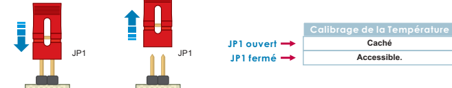
Fig. 4. Inhibition du calibrage de la température par hardware.
