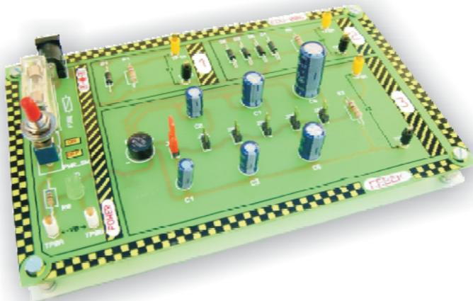
La Edu-006 está compuesta por cuatro prácticas o experimentos que permiten contrastar y visualizar el comportamiento de las distintas configuraciones de puentes rectificadores.
