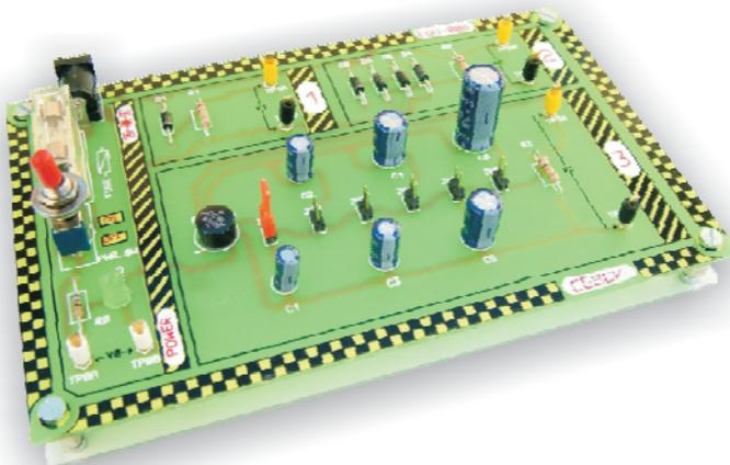
La leçon pratique Edu-006 comprend quatre leçons ou expérimentations permettant de comparer et observer le comportement des différentes configurations de ponts rectificateurs.
