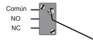
**Nota.** el microinterruptor, va provisto de terminales tipo Faston®
