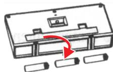
3 baterías recargables Ni-Cd, tamaño AA, de 600mAh - 1,2V
