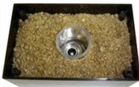
Remplissez la boîte avec du sable. Boucher le tube pour remplir la zone pour empêcher le sable dans le palier
