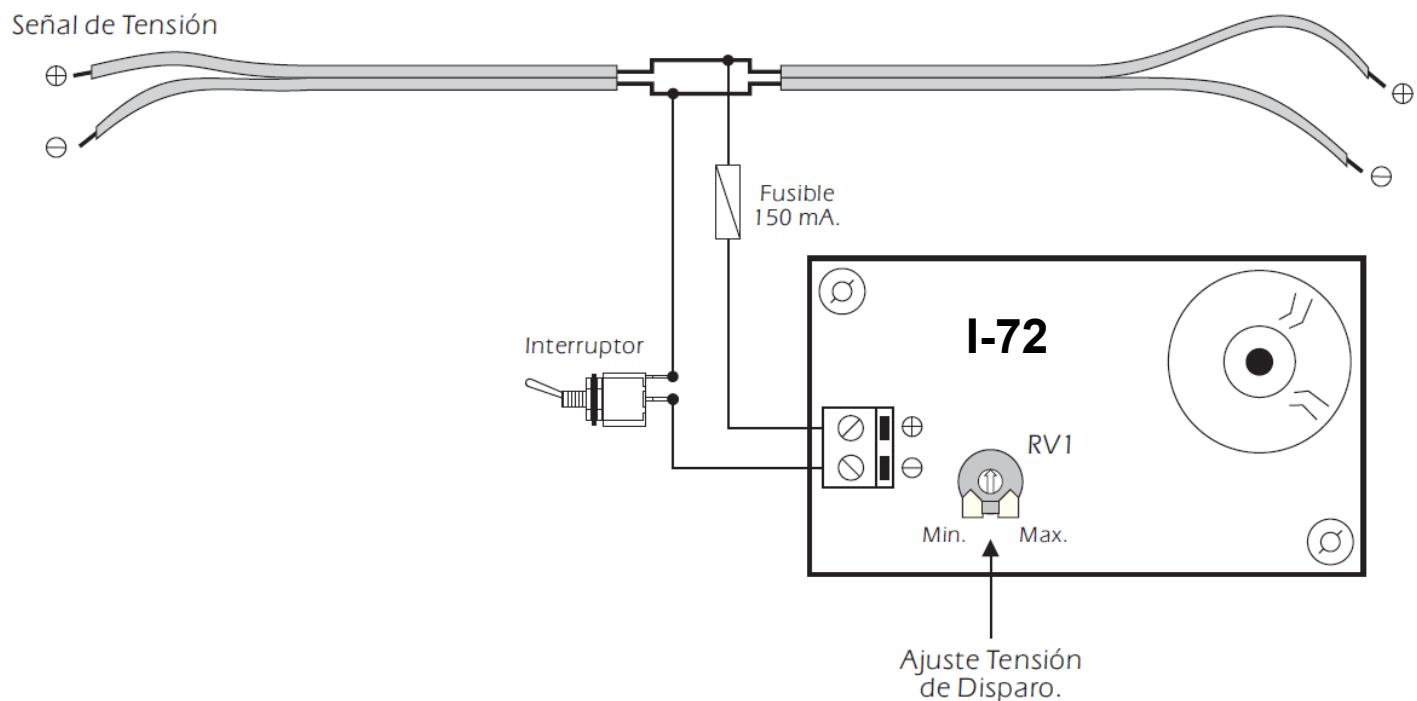
**Conexión en Paralelo del Módulo a la Toma de Tensión a Controlar.**
