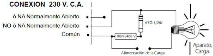
**NOTA:** para conectar cargas a 12 V. C.C., eliminar resistencia y poner solo condensador
