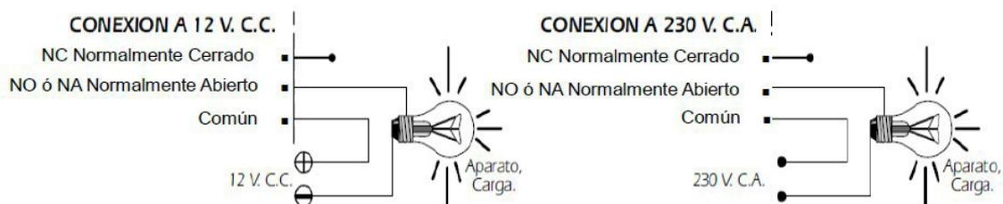
**CONSIDERACIONES SOBRE LA SALIDA.** Durante el funcionamiento del circuito, y según sea su carga, podrá producirse una fluctuación o un incorrecto funcionamiento de la salida. Si esto ocurre, instale un circuito antichispas entre los dos contactos del relé utilizados en la conexión, tal y como se muestra en el dibujo
