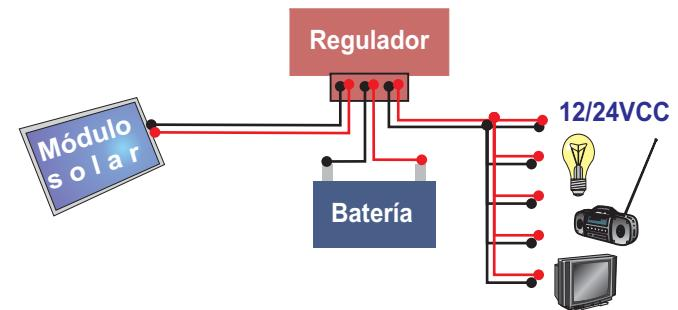
Es necesario prestar atención a la correcta polaridad de los bornes y/o de los cables al conectar el módulo
