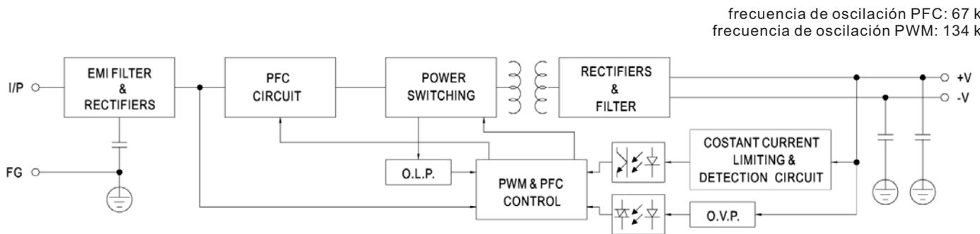
frecuencia de oscilación PFC: 67 kHz
