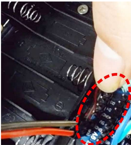
Figura 9 – 5 : Situación de los contactos en el módulo Shield, donde enchufaremos el conector hembra del cable. Queda justo al lado del conector de la alimentación del módulo controlador de motores. Atención a la polaridad
