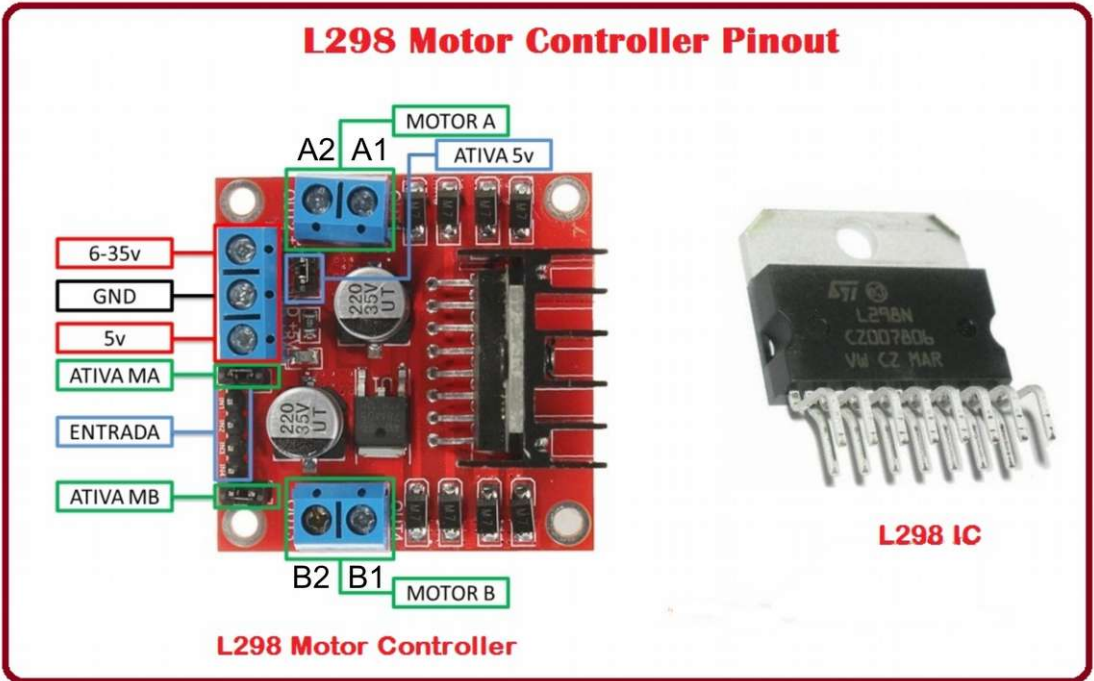
Figura 7 - 3: Conectar los cables del motor izquierdo a la parte izquierda del módulo controlador de motores (bornes A1 y A2) y los del motor derecho a la parte derecha (bornes B1 y B2)
