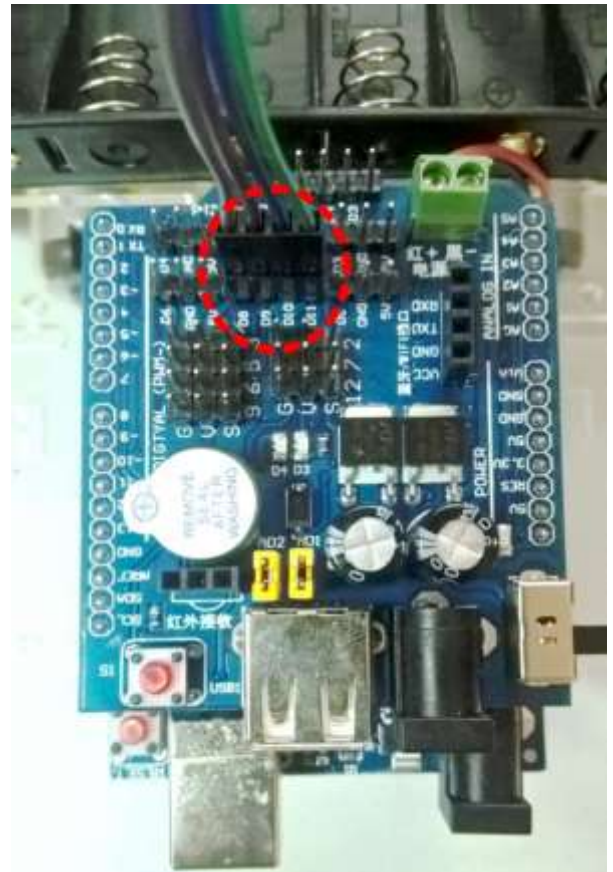
Figure 8 - 2 : Connecteur connecté sur le module Shield
