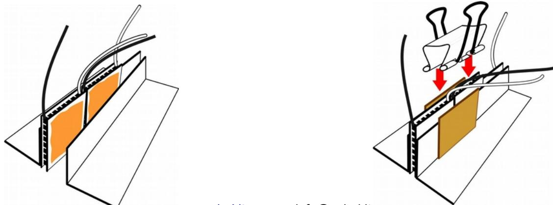
Para conectar los módulos en serie es necesaria una regleta suplementaria. Fíjate bien en la siguiente figura que muestra como debes hacer la conexión del motor con los dos módulos en serie. Es muy importante que te fijes en las polaridades (colores de los cables).
