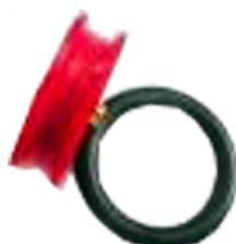
C) Colocar el anillo de caucho 24 x 5mm. Ajustar el tubo de latón para que sobresalga 2mm por cada lado.
