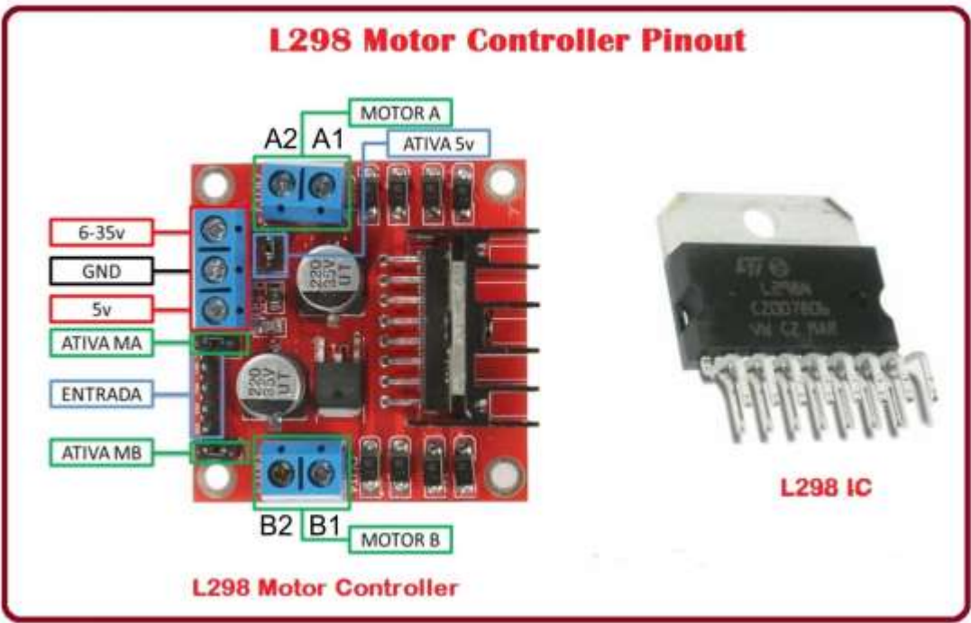
Figure 7- 3 : Connecter les câbles du moteur gauche à la partie gauche du module de contrôle des moteurs (bornes A1 et A2) et ceux du moteur de droite à la partie droite (bornes B1 et B2)
