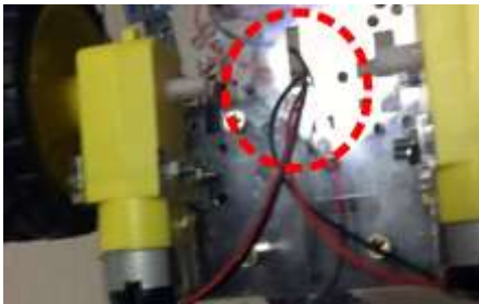
Figure 7- 2 : Introduire les câbles des moteurs à travers le trou du centre du châssis acrylique et les faire remonter jusqu’au modules de contrôle des moteurs
