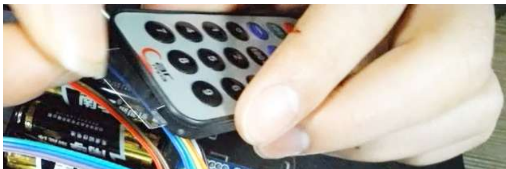
Figura 9 – 1 : Tirar del aislante hacia fuera hasta sacarlo del mando Guardar el aislante
