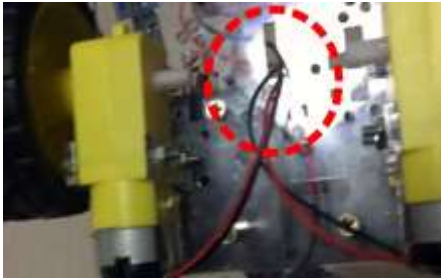
Figure 6- 2 : Introduire les câbles des moteurs à travers le trou du centre du châssis acrylique et les faire remonter jusqu’au modules de contrôle des moteurs
