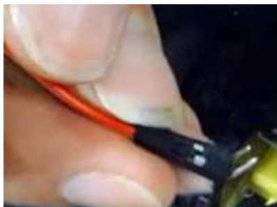
Figure 7 – 4 : Pour l'alimentation du module de contrôle des moteurs il est nécessaire d'utiliser un câble spécial. À une extrémité il a deux connecteurs avec deux pins mâles accoudés qui sont connectés au bornier du module de contrôle des moteurs.
