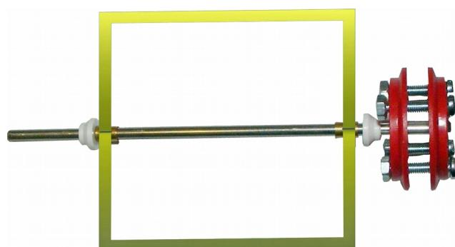
**NOTA : Unas gotas de aceite de motor en el interior de los casquillos de latón, harán funcionar el mecanismo con más finura.**
