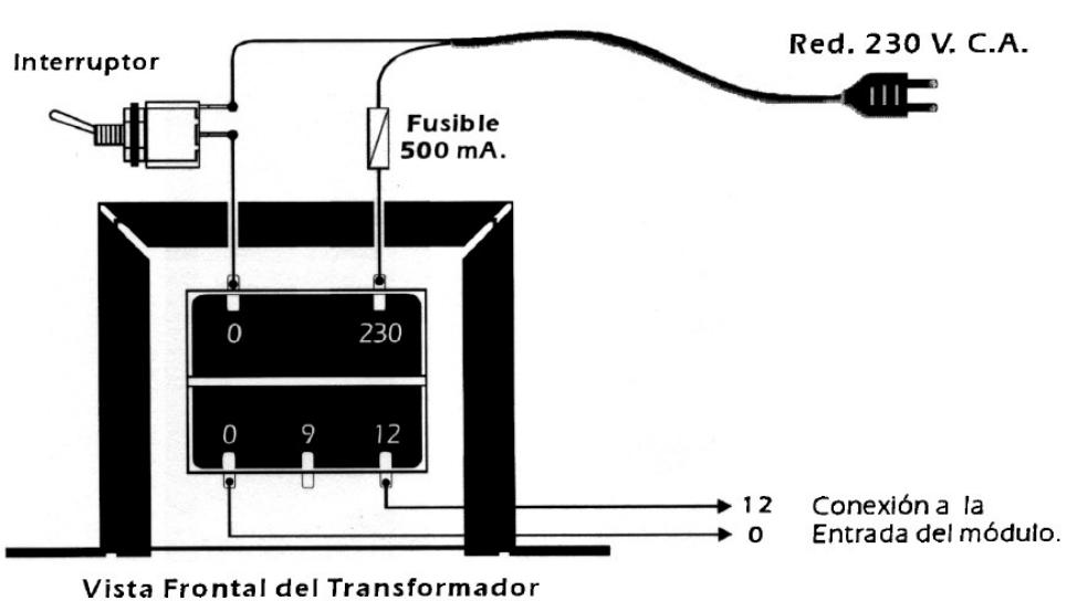
**CONEXIONADO DEL MODULO.** Una vez haya realizado el conexionado del transformador prosiga con el módulo. Asegúrese primero que todavía no circulan 230 V. de la red. Conexione los dos terminales inferiores del transformador con las inscripciones "0" y "12" al borne de entrada del módulo. Realizada esta operación, accione el interruptor de alimentación. El led del circuito se iluminará y la fuente proporcionará en su salida 9 V.C.C.
