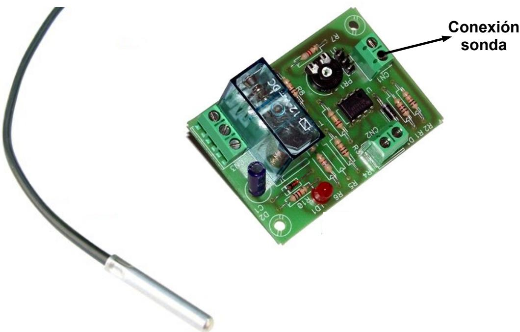
**NOTA.** Conectar los 2 hilos de la sonda al conector marcado como conexión sonda.
