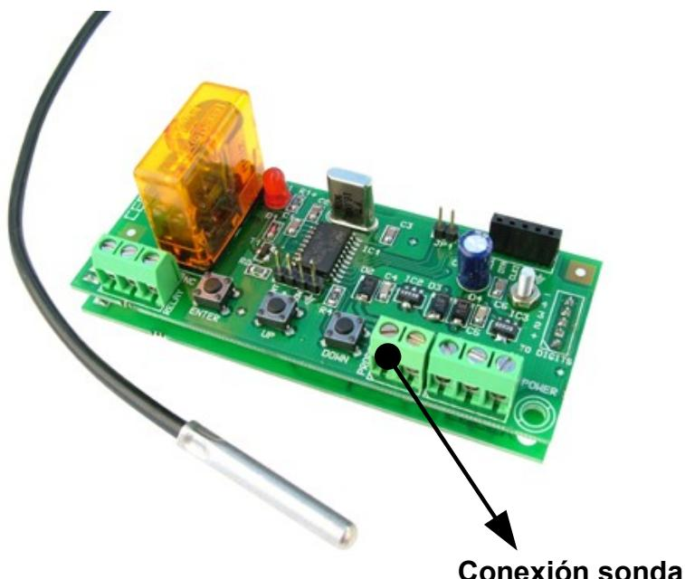
**NOTA.** Conectar los 2 hilos de la sonda al conector marcado como conexión sonda.
