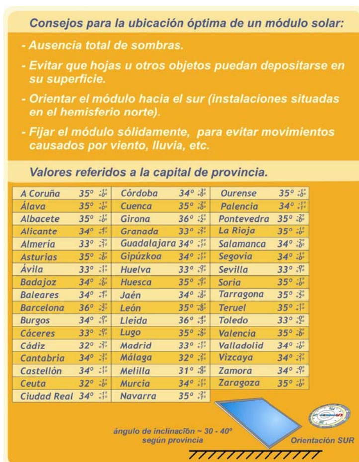
Fig. 2. Orientación e Instalación de los paneles fotovoltaicos.
