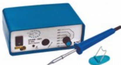
ST-80200 Estación de soldadura PRO de 80w a 230Vca Estación profesional de 80w . Incluye soldador 24V/80W con varilla diámetro 6,5 mm y sensor térmico . Control calefacción : 150-450 ° C
