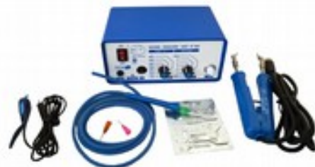
ST-50405 Estación SMD de posicionado, soldar y desoldar de 50w a 230Vca Para la manipulación (pick and place) de los componentes SMD, la unidad de succión por vacío con control electrónico, permite levantar, transportar y situar adecuadamente los componentes SMD. Control de calefacción de 150° a 450°C
