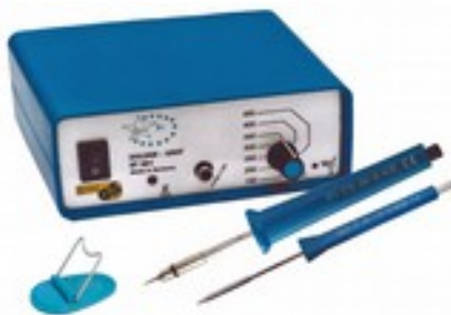
ST-30105 Estación de soldadura DUAL de 30W a 230Vca Completísima estación de soldadura equipada con dos soldadores enchufables. Un pequeño soldador de 12V/7,5W que es específico para trabajos de soldadura de alta precisión y un soldador de 12V/25W, que permite realizar la práctica totalidad de los trabajos habituales de soldadura en circuitos electrónicos. Control calefacción : 150-450 ° C
