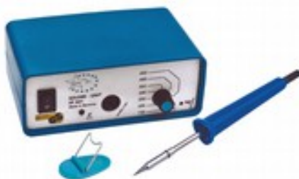
ST-50100 Estación de soldadura PRO de 50w a 230Vca Estación profesional de 50w . Incluye soldador 24V/50W con varilla diámetro 6,5 mm . Control calefacción : 150-450 ° C
